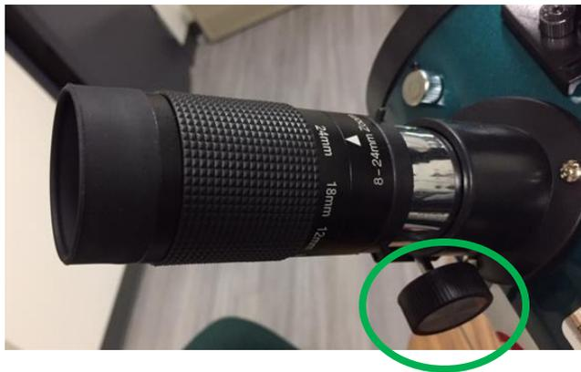
7. Pour augmenter le grossissement, passez graduellement de 24 mm à 8 mm en tournant la partie mobile de l'oculaire. À chaque ouverture, vous obtiendrez un grossissement supérieur.
